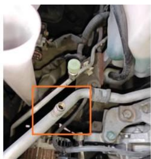
Tutup Nipple Pipa Freon Tidak Ada
