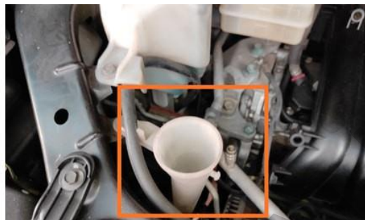
Tutup Air Wiper Tidak Ada
